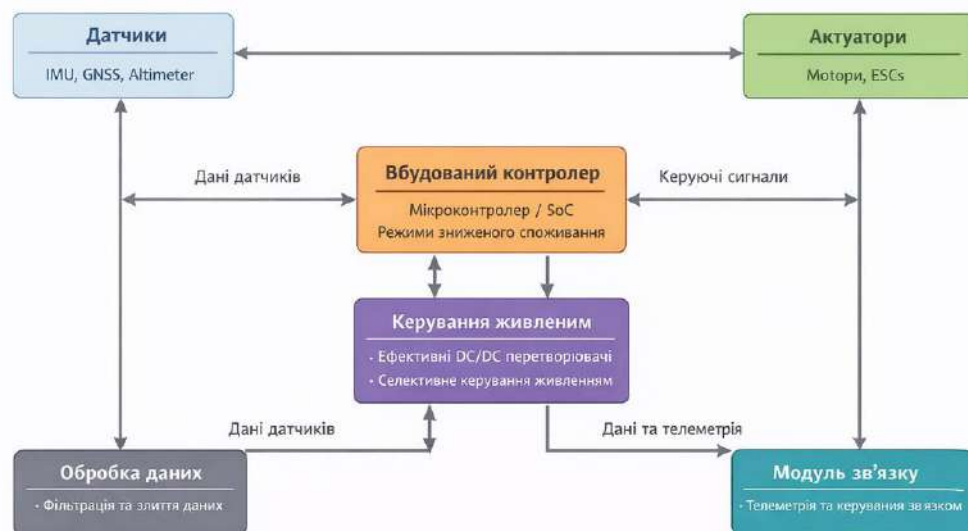
Рисунок 1.1 – Блок-схема архітектури енергоефективної вбудованої системи керування БПЛА
