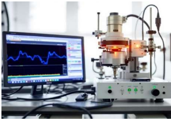
Рисунок 1. Проект комплексу реєстрації оптичних сигналів. Формування сигналу → Поширення в середовищі → Перетворення фотонів у струм → Програмна обробка та аналіз сигналу → Візуалізація / Збереження
