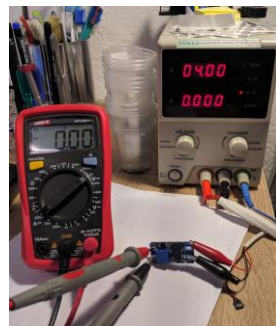
Рисунок 3 – Макет тесту плати MT3608
