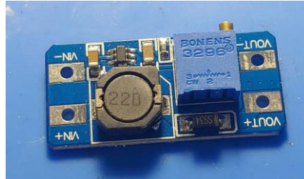
Рисунок 2 – Модуль підвищення та стабілізації напруги МТ3608
