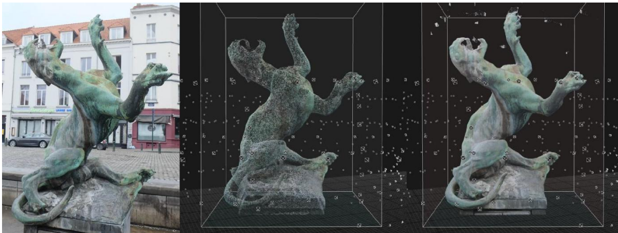
Рисунок 1 – Етапи створення 3D-моделі методом фотограмметрії
