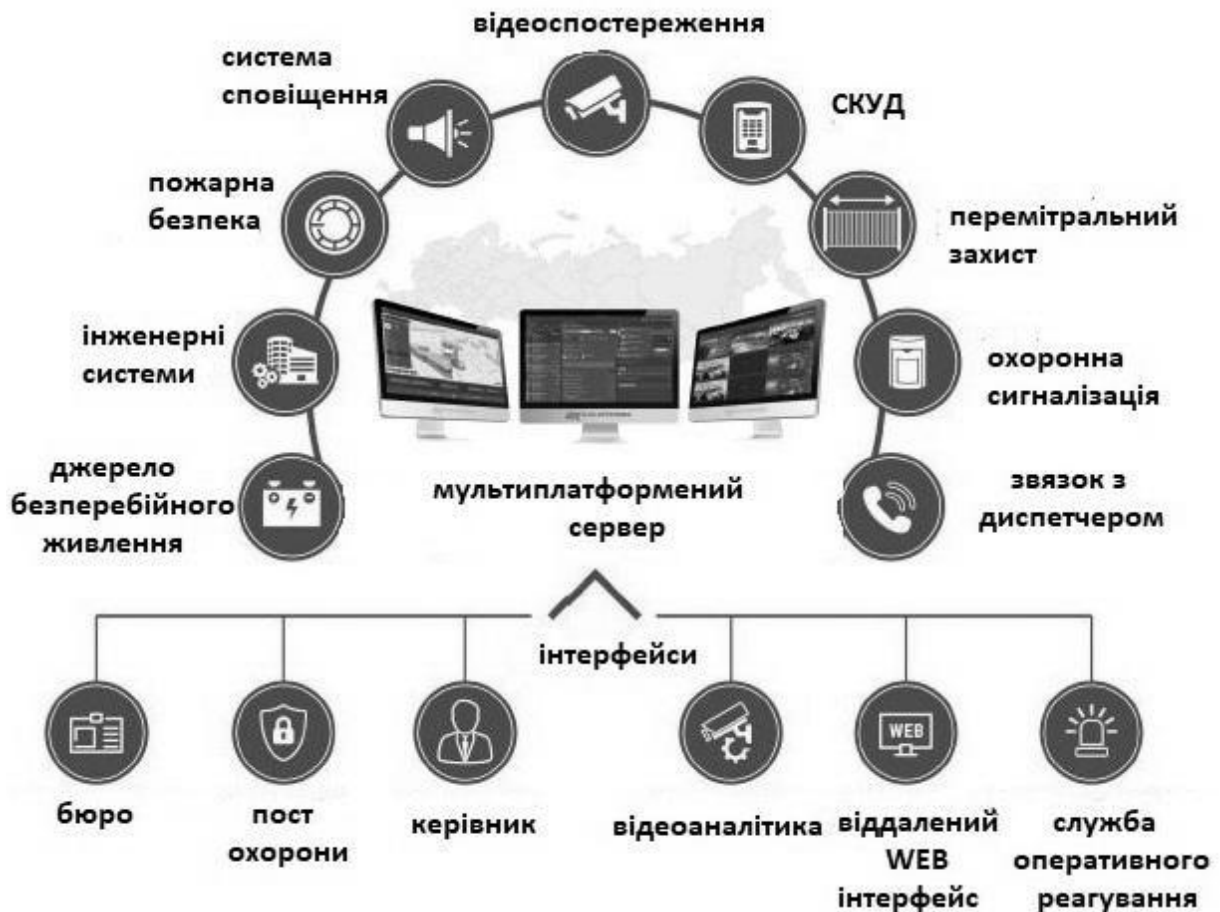
Рисунок 1 – Структурна схема роботи платформи PSIM
