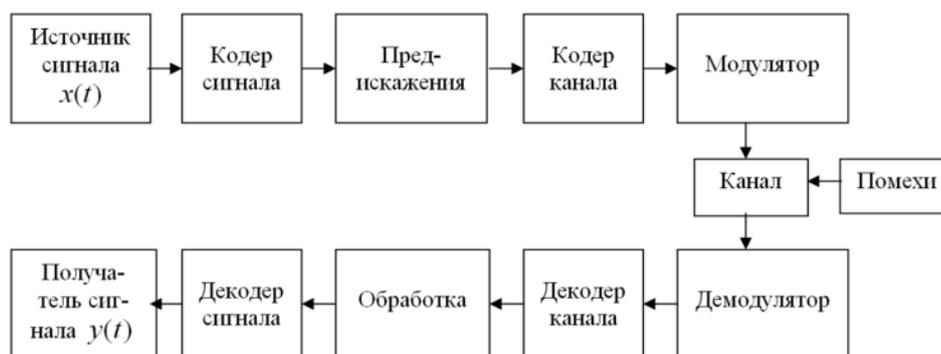
Рисунок 1 – Обобщенная схема цифровой обработки сигналов.
